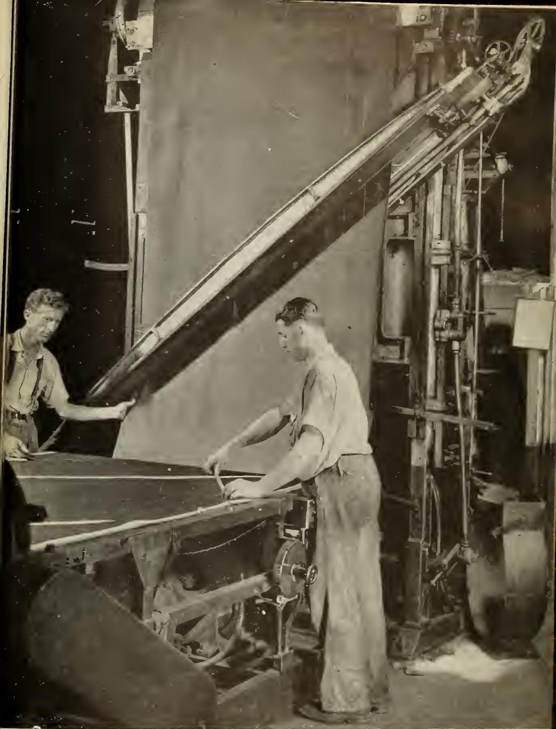
da fase da fabricação está entregue a operários especializados. Na foto acima vemos um "spadon" em funcionamento, máquina destinada a cortar a lona calandrada, para o revestimento dos pneumáticos
